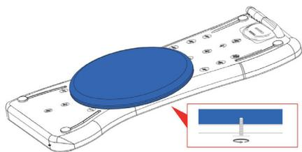
**Шаг 3.** Вставьте поворотный диск в центр доски для ванны и закрепите с помощью круглого болта. Не перетягивайте болт, чтобы поворотный диск мог продолжать вращаться.
