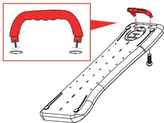
**Шаг 1.** Вставьте красную ручку в отверстия на сиденье и закрепите с помощью круглых болтов
