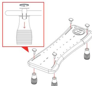
**Шаг 2.** Присоедините ножки к доске для ванны с помощью прямоугольных болтов и пластиковых шайб
